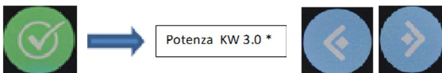
Con i due tasti laterali, Freccia a Destra e Freccia a Sinistra, si può incrementare o decrementare la potenza.
