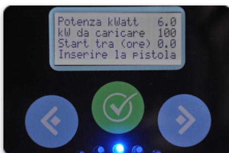
La ricarica parziale si effettua premendo due volte il tasto Verde centrale per posizionare il cursore sulla riga: **kW da caricare 100\***
