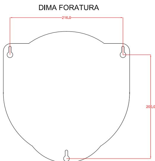
2. Avvitare le viti quasi completamente, lasciando qualche millimetro per poter inserire la WallBox
